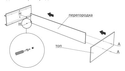
Если у Вас двухдверный шкаф-купе, то крепим сначала полки, затем бока и ребро жесткости. Полки, находящиеся друг напротив друга, крепятся между собой двухсторонним эксцентриком (L и H).
