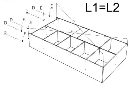
Крепим заднюю стенку ДВП на гвозди(D) и скобы(C) с шурупами 3x25(B).
