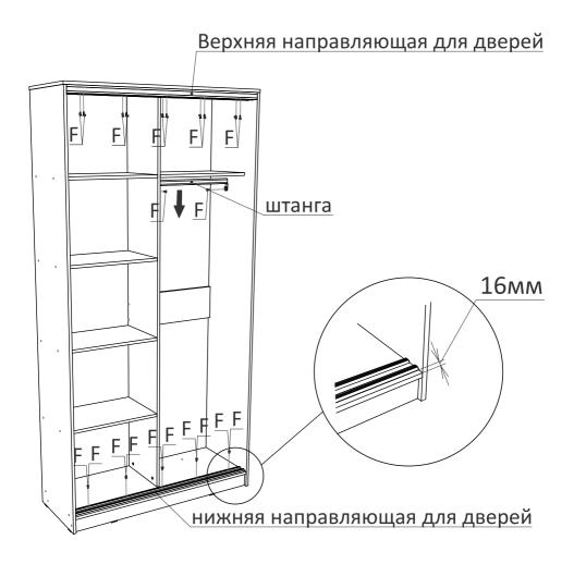
Вставляем двери. Сначала заводим верхнюю часть дверей, потом нижнюю: первую дверь в дальние пазы направляющих, вторую дверь в ближние.
