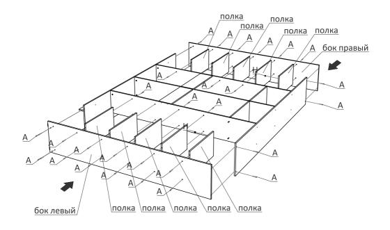
Прибиваем пластиковые наконечники к цоколю и бокам гвоздями. При установке задней стенки ДВП необходимо проследить, чтобы все углы шкафа были прямыми. Для этого необходимо выставить диагональ шкафа. Расстояния между противоположными углами должны быть одинаковыми L1=L2.
