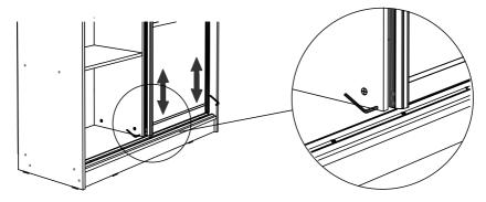
Когда двери отрегулированы, следует правильно настроить стопоры. Они нужны для того, чтобы двери неподвижно стояли в закрытом положении. Выставите их таким образом, чтобы колесико точно попадало на стопор, а торец двери не доходил до стенки примерно сантиметр. Теперь можно наклеить ворсяную ленту (шлегель) на вертикальные торцы дверей.
