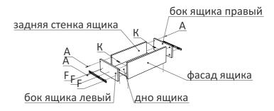
Далее собираем ящики. Задняя стенка и бока крепятся на конфирмат (A), фасад на эксцентрики (К и Н), дно прибивается гвоздями. Затем прикручиваем малую часть направляющих на шурупы 3,5х16(F). Вставляем ящики в направляющие в шкафу.
