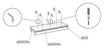
Для начала крепим цоколь ко дну шкафа. Крепится он конфирматами(A). Теперь собираем корпус шкафа. Пока шкаф полностью не собран, следите за тем, чтобы прикрепленные детали не наклонялись, так как крепления могут быть выломаны. У двухдверного и трехдверного шкафа крепим дно, перегородки и топ (крышу), а у четырехдверного только дно и перегородки.
