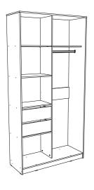
Если в Вашем шкафу есть ящики, то сначала разъединяем шариковые направляющие. Для этого нужно полностью раздвинуть саму направляющую, поднять или опустить пластиковый курок и вытащить одну ее часть. Делаем это со всеми направляющими.
