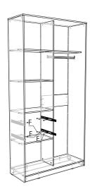
Теперь прикручиваем основную (длинную) часть направляющих к перегородке и боку шкафа на шурупы 3,5х16(F).
