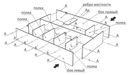
Если у Вас трехдверный или четырехдверный шкаф, то сначала крепим средние полки и ребра жесткости, только после этого остальные полки. Полки, находящиеся друг напротив друга, крепятся между собой двухсторонним эксцентриком (L и H). Далее нужно закрепить топ (крышу) и бока.
