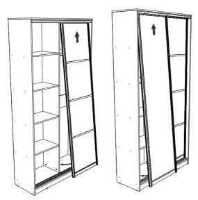
Шестигранником регулируем наклон дверей через нижнее отверстие.
